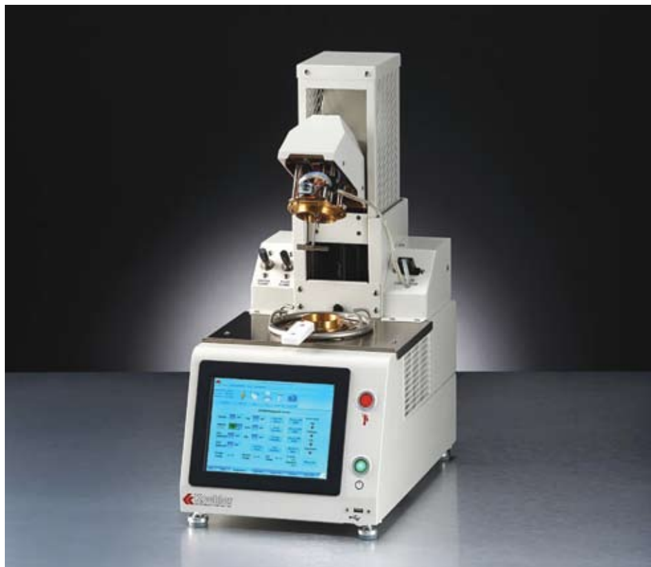
Рис. 1. Блок крышки/мотора и сенсорного дисплея автоматического прибора с закрытым тиглем Пенски-Мартенса для определения температуры вспышки [7]
